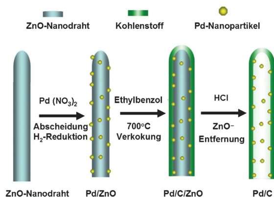
Schema 1. Der dreistufige Prozess zur Herstellung des Pd/C-Nanokomposits mit Pd-NP auf der Innenseite der CNTs. 1) Abscheidung der Pd-NP auf ZnO-Nanodraht; 2) Ummantelung mit einer Kohlenstoffschicht; 3) Entfernung des ZnO-Nanodrahts mittels verdünnter HCl.
